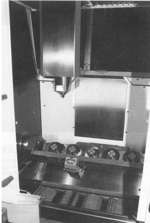
Die Spannbrücke auf einer Hermle C800U: In erster Linie werden hier Sonderzangen für die Chirurgie bearbeitet.
